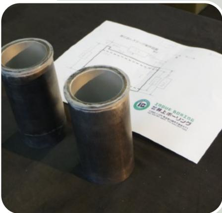
内径をアルミ化しメッキ仕上げする事で铸铁スリーブに比較して、摩耗が圧倒的に少なく、軽量で、放熱性がよく、滑りもよい理想的なシリンダー内径を造ることができます。メッキ内のシリコンの硬度はヴィッコース硬度で2,000以上！！
